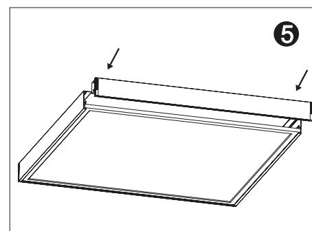
5. Encaje de nuevo el lado retirado previamente, la instalación ha terminado.
